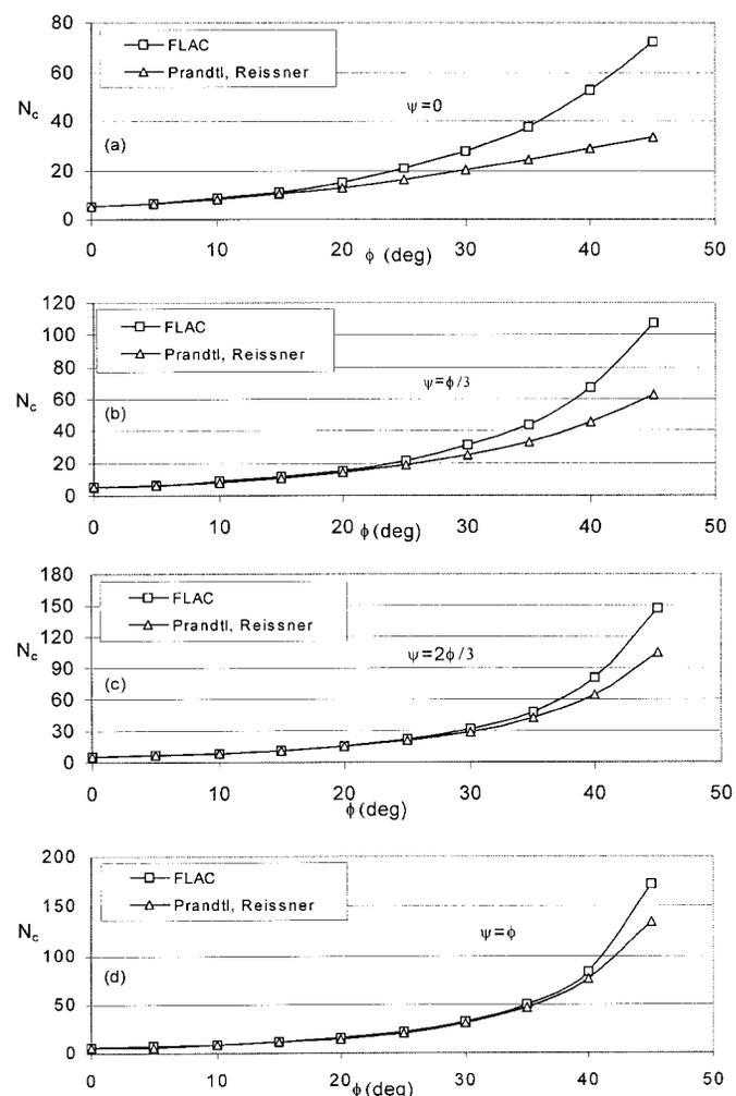
**FIG. 4.** Comparison of  $N_c$ : (a)  $\psi = 0$ ; (b)  $\psi = \phi/3$ ; (c)  $\psi = 2\phi/3$ ; (d)  $\psi = \phi$
