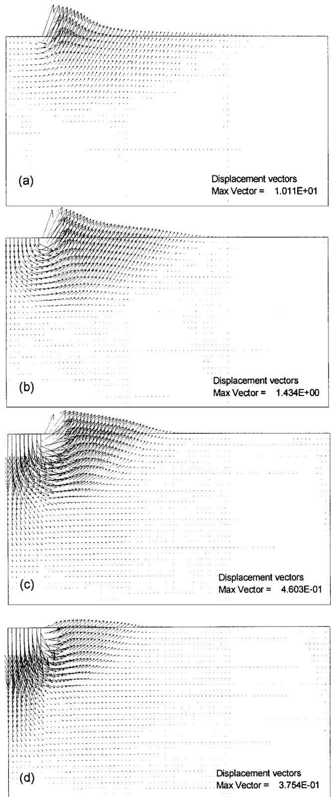
**FIG. 2.** Displacement Vector for  $N_R$ : (a)  $\psi = \phi$ ; (b)  $\psi = 2\phi/3$ ; (c)  $\psi = \phi/3$ ; (d)  $\psi = 0$
