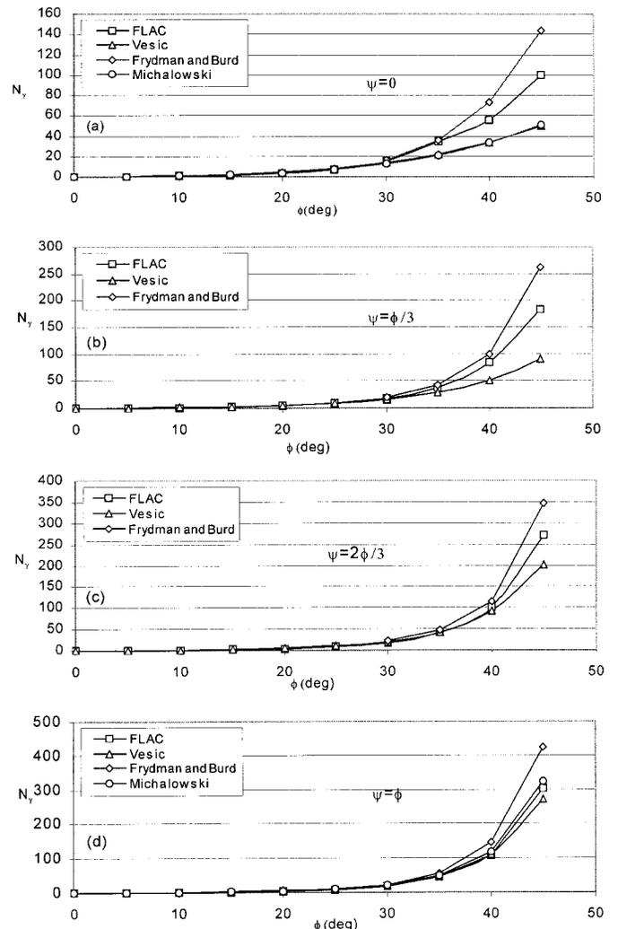
**FIG. 6.** Comparison of  $N_c$ ,  $N_q$ , and  $N_\gamma$ : (a)  $\psi = 0$ ; (b)  $\psi = \phi/3$ ; (c)  $\psi = 2\phi/3$ ; (d)  $\psi = \phi$
